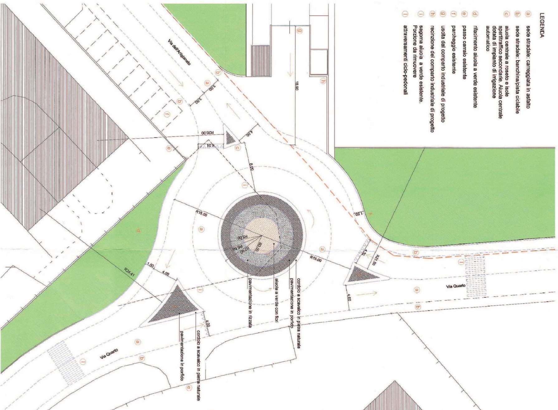
NOTA: le isole secondarie apertinenti sono realizzate con cordoli in pietra naturale a scacchiera e pavimentazione in portido su letto di sabbia e massello in cemento come da particolare riferito nella sezione della rotatoria
